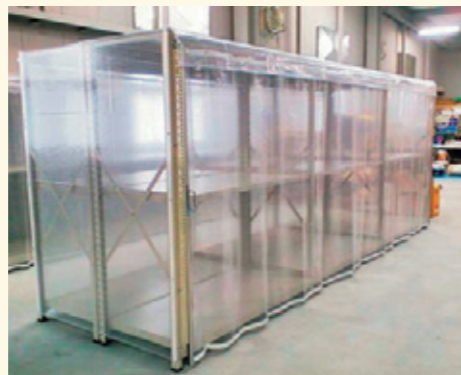
防塵 ビニールシート、D30レール、間仕切ポール使用
