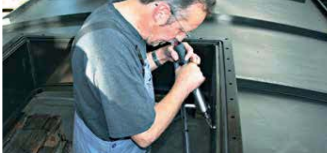
ダイオード PID で、PEコンテナの肉盛り溶接。
