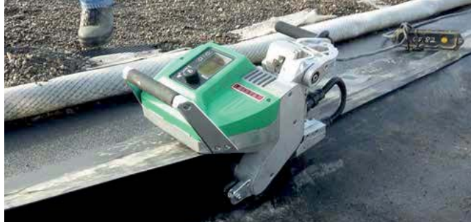
ジオスターの実地試験 (南アフリカ) では、一回の作業で 240 m を楽々と溶接
