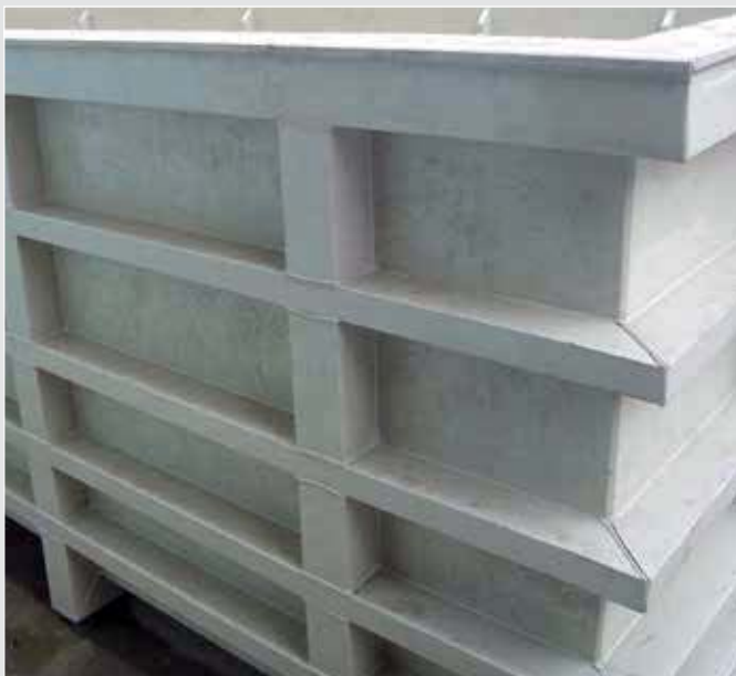
電気めっき槽、トルコ。材質：PP
