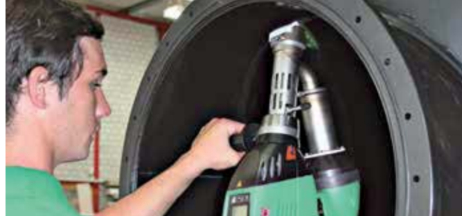
パイプの内側でも簡単に溶接可能
