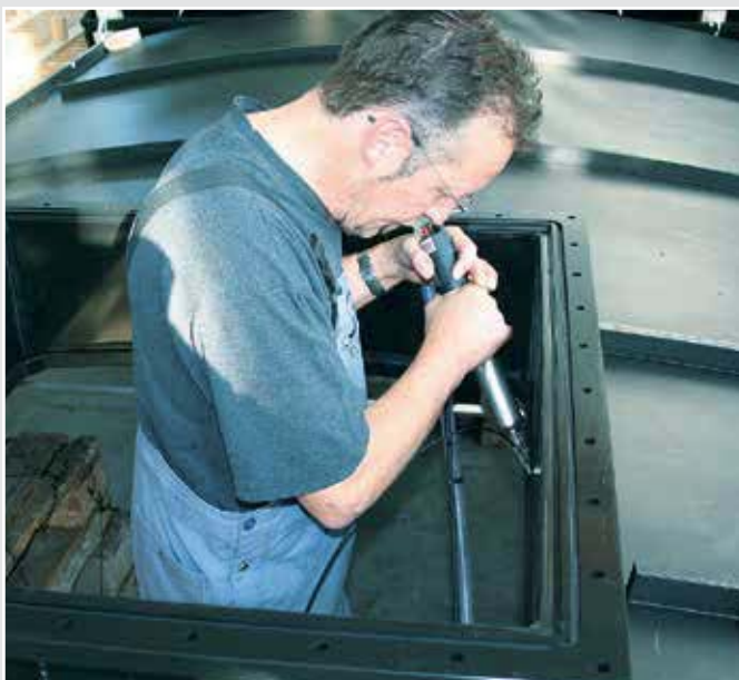
押出溶接の際にタンクディテールに使用されるダイオードS。
