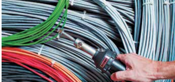
ホットストリームにコの字型リフレクターを装着し、半田付き収縮チューブのシュリンクをしています。
