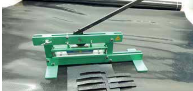
均一寸法のテストピース、クーポンカッターで迅速に生成。
