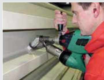
困難な場所での溶接を簡単にします： ウェルドプラスト S2 の 45°アングルヘッド(アクセサリ)
