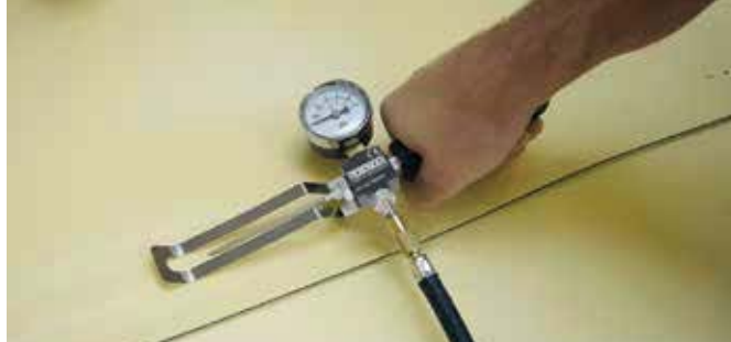
テストチャンネル付きオーバーラップシーム溶接の気密性検査
